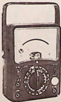
EP.100LN Universeelmeter met ingebouwde transistor tester, 100.000 ohm/volt. DC Volt: 0-0.12 0.6, 3, 12, 30, 120, 600 V. AC Volt: 0-6, 30, 300, 600 V. DC stroom: 0-12 \mu A, 600 \mu A, 12 mA, 300 mA, 12 A. Weerstand: 0-10 K ohms, 0-1 M ohms, 0-10 M ohms. Decibels: -20 db tot +18 db. Transistors: ICO 0-12 \mu A, Alpha 0-0.9965, Beta 0-280
